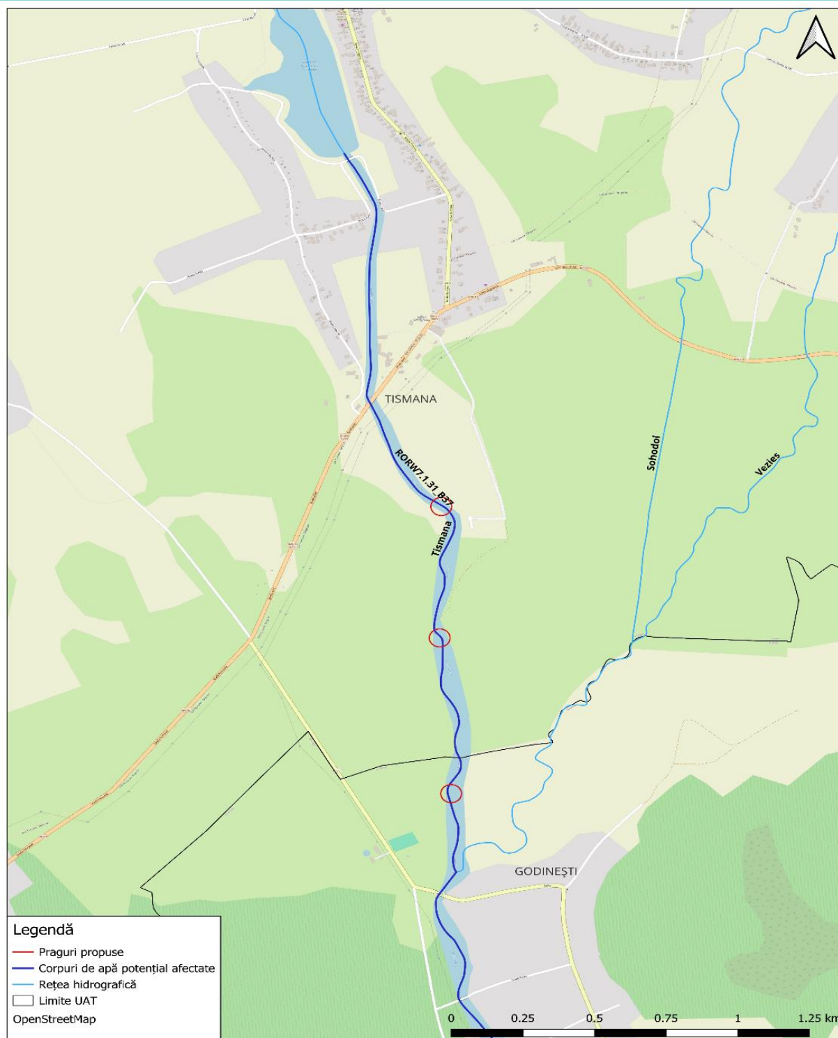
Figura 5. Prezentarea lucrărilor principale propuse pe corpul de apă Tismana (praguri de fund)
