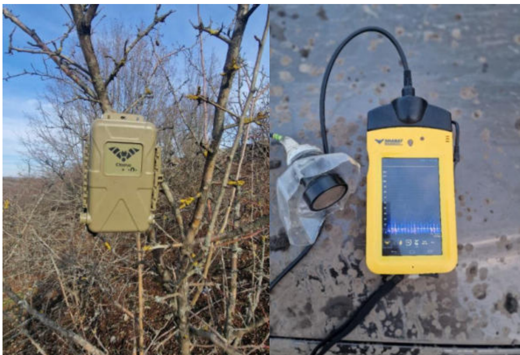
Fig.75-76: Detector manual pentru transectele de ultrasunete – Tip Anabat Walkabout cu GPS incorporat (dreapta), Detector static – Tip Anabat Chorus cu GPS incorporat (stânga)
