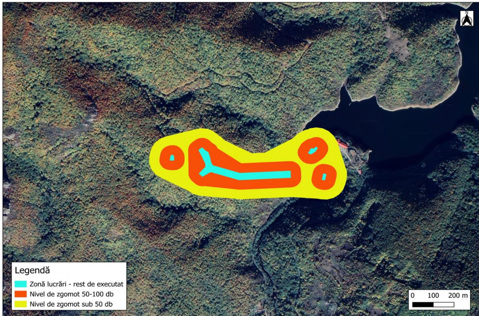
Fig. 206 Dispersia zgomotului din zonele cu lucrări
