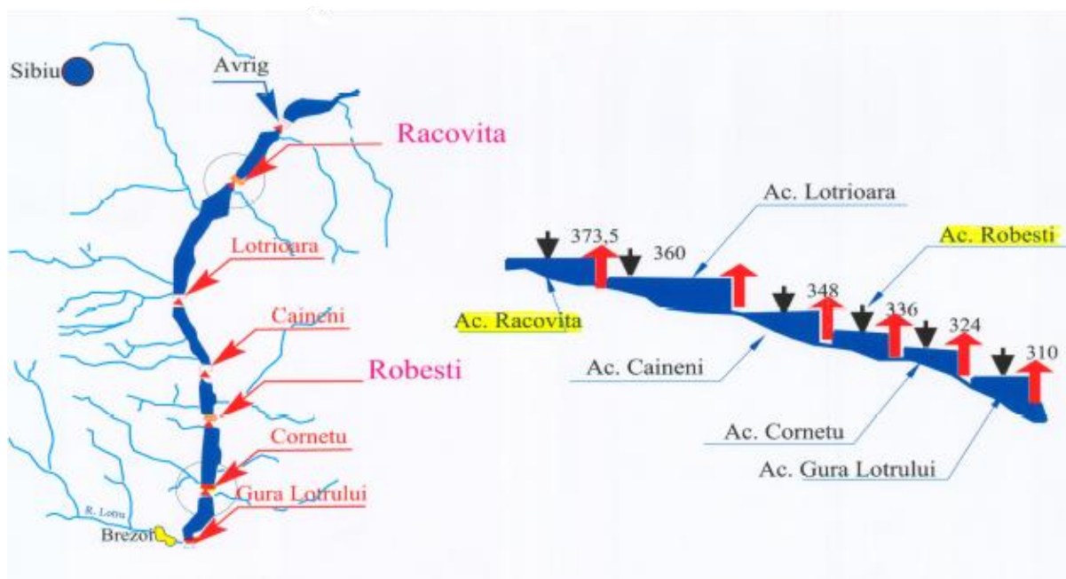
Figura nr. 17 Schema amenajării râului Olt pe sectorul Cornetu –Avrig, conform soluției constructive din Decretul 24/1989
