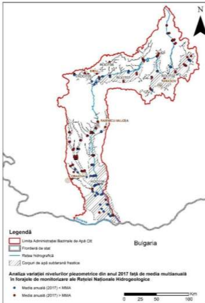
Figura 6.24 Analiza evoluției nivelurilor hidrostatice multianuale în forajele de monitorizare cantitativă de la ABA Olt
