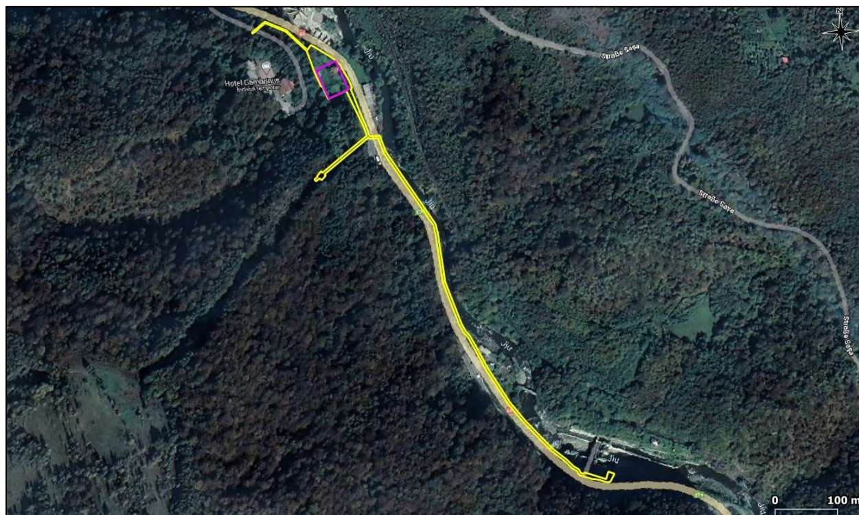
Fig. 24 – Încadrarea în teritoriu a suprafețelor vizate de implementarea componentei proiectului ce vizează racordarea CHE Dumitra la SEN (polilinii de culoare galbenă – trasee linii electrice, poligon de culoare mov – stație de transformare 110 kV)
