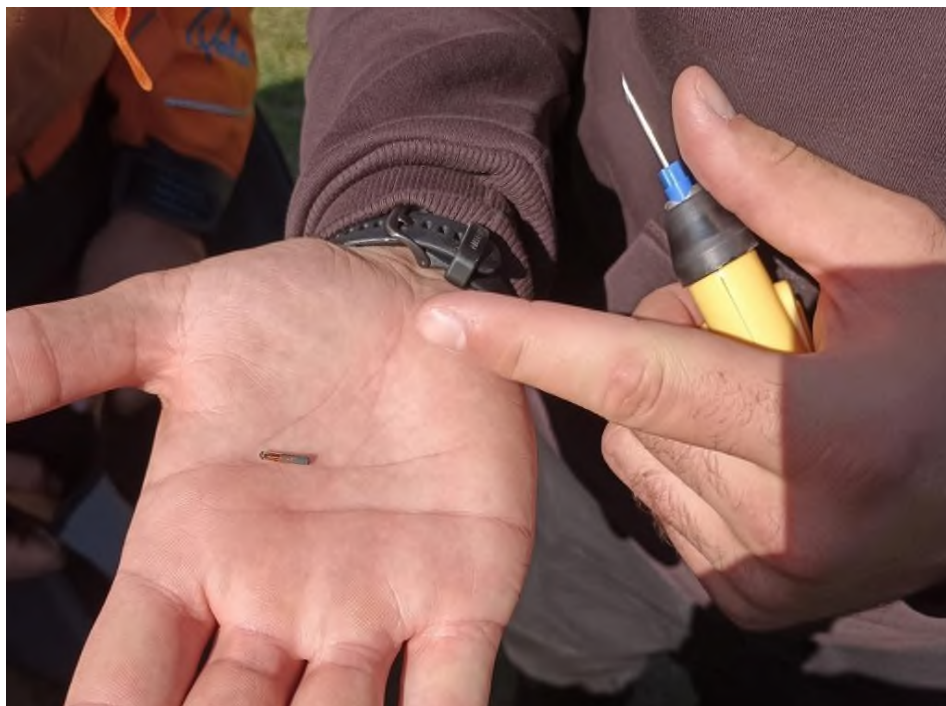
Fig. 149 Exemplu de "PIT Tag" + ac și pistol utilizat la marcarea speciilor de pești în vederea monitorizării scărilor de pești.
