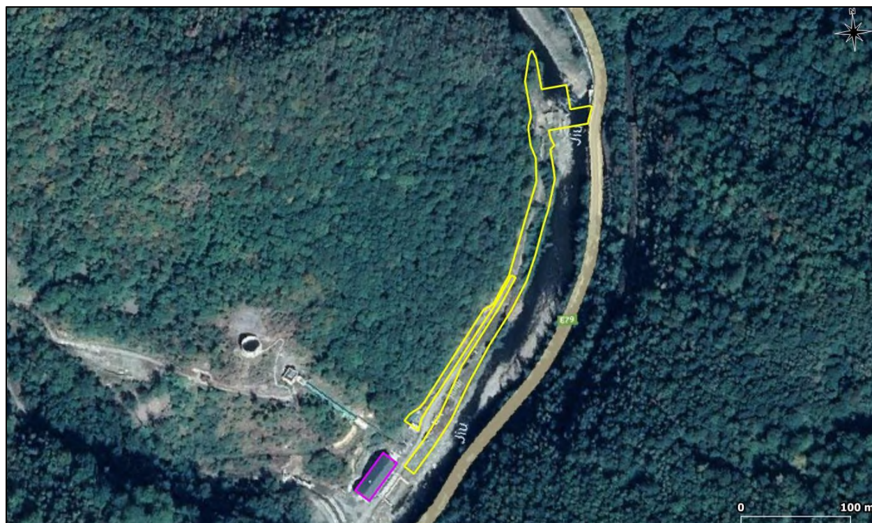
Fig. 17 – Încadrarea în teritoriu a captării secundare Jiu – inclusiv traseu conductă aducțiune și drum de operare (poligon de culoare galbenă); clădirea CHE Dumitra (poligon de culoare mov)
