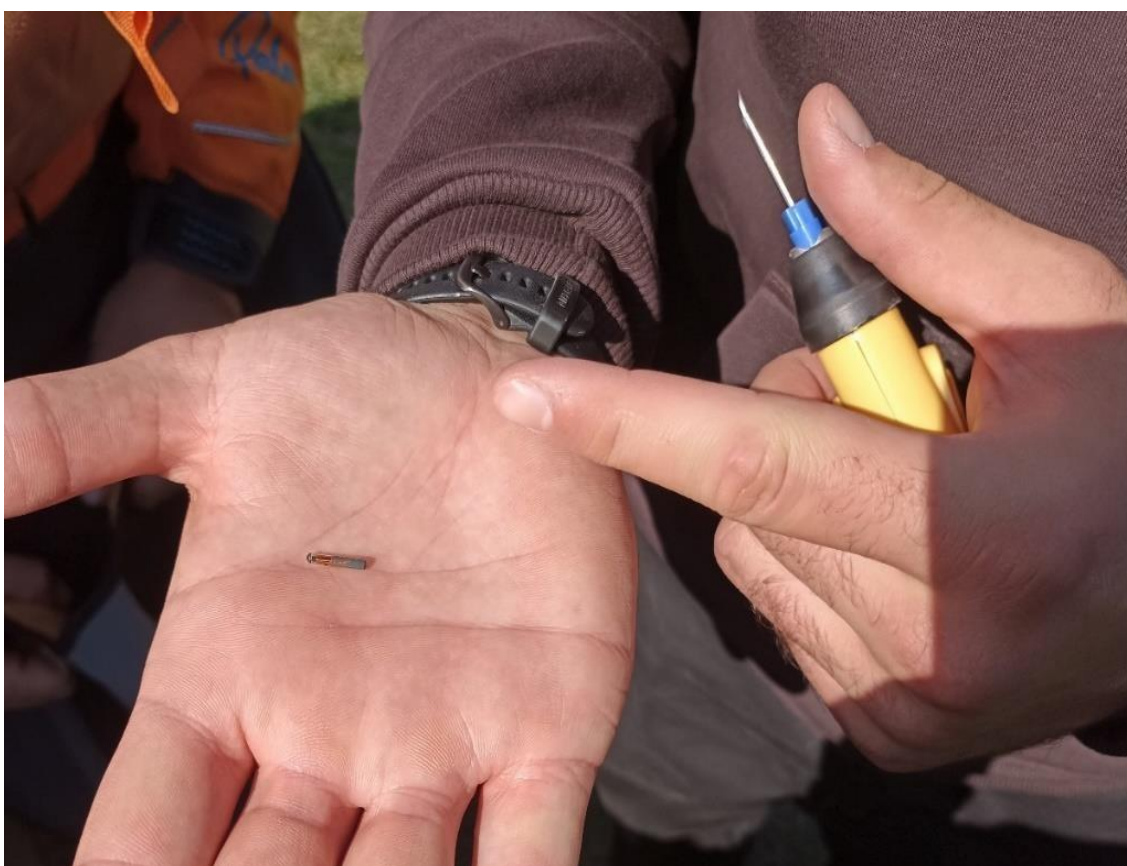
Foto 78 Exemplu de "PIT Tag" + ac și pistol utilizat la marcarea speciilor de pești în vederea monitorizării scărilor de pești
