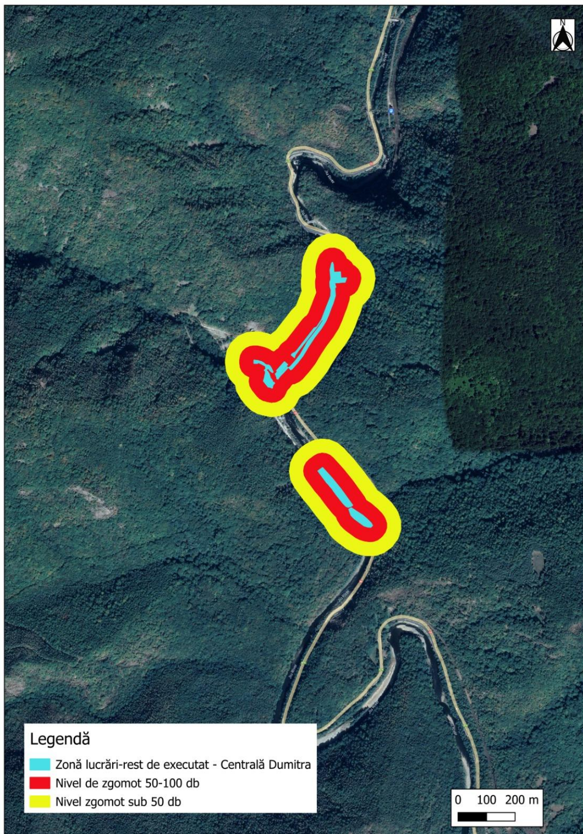
Figura nr. 40 Dispersia zgomotului din zonele cu lucrări – CHE Dumitra
