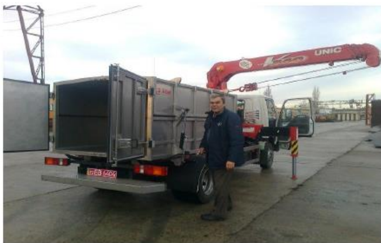
Figura 2.6. Vehicul special OT-20 pe șasiu ISUZU
