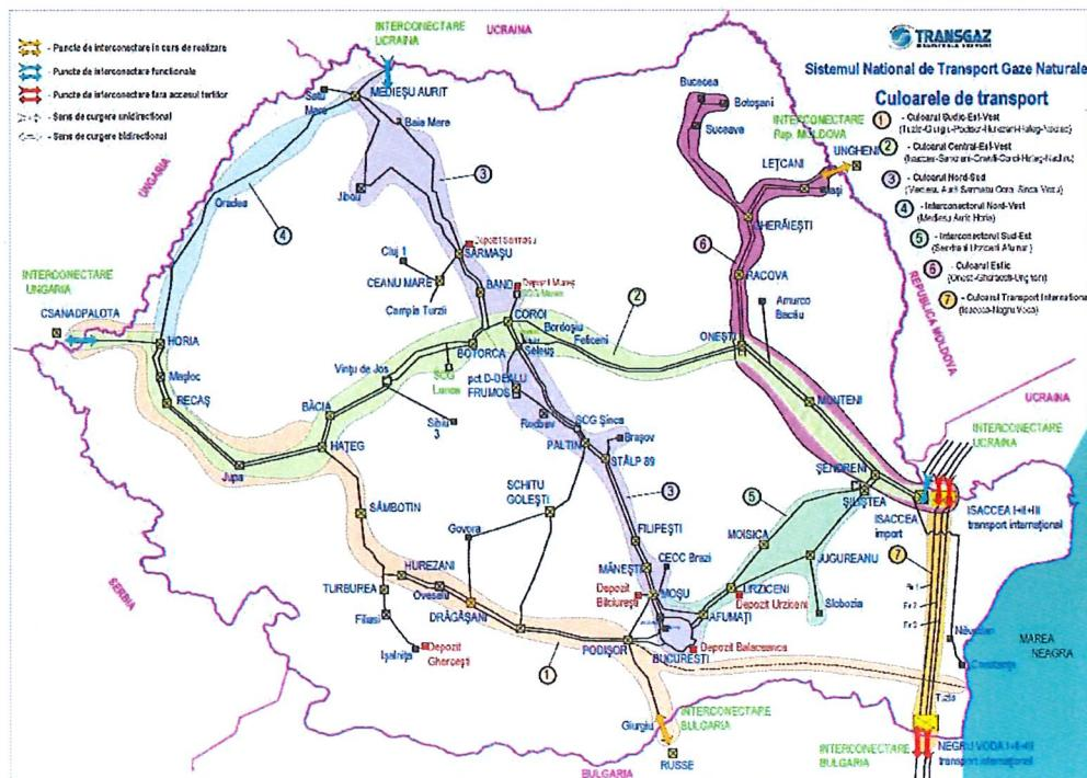
Figura 6 - Culoarele de transport gaze naturale din SNT
