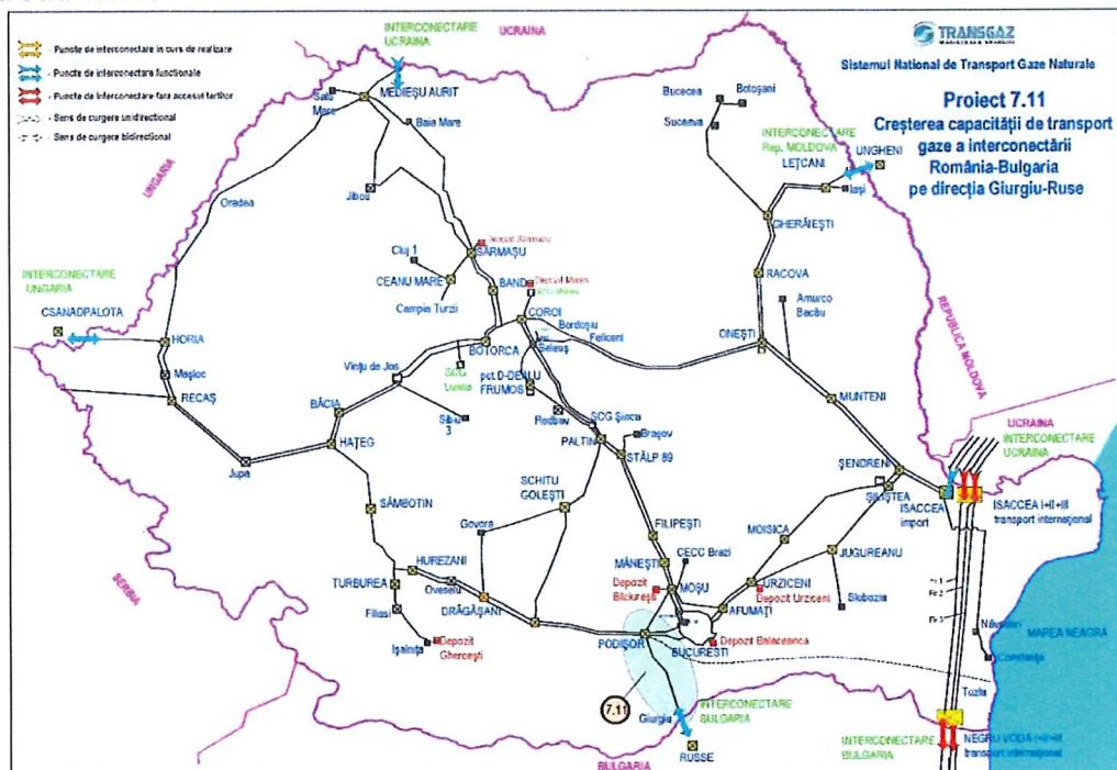
**Figura 18- Creșterea capacitatei de transport gaze naturale a interconectării România-Bulgaria pe direcția Giurgiu-Ruse**
