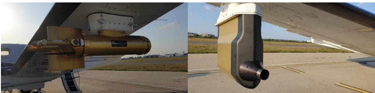
Figura 11. În imaginea din stânga se află instrumentul CAPS, iar în cea din dreapta se poate observa instrumentul Hawkeye. Ambele instrumente se află montate pe aeronava Beechcraft C90 GTx
