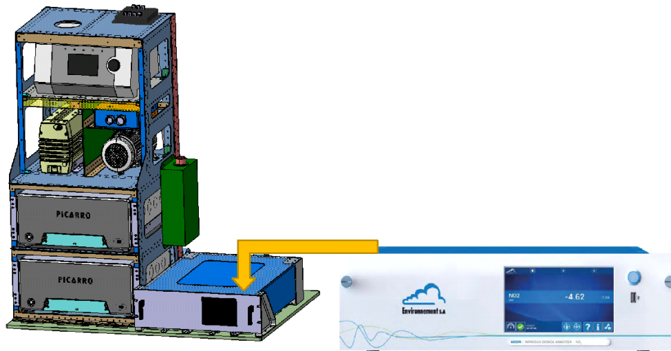
Figura 4. Vedere izometrică a poziției analizorului NO 2 CAPS în interiorul cabinei.
